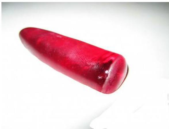
Figure 8 - « Bouteille » de rubis obtenue par procédé Verneuil
