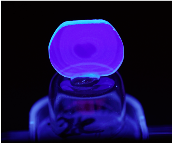
Figure 4 - Fluorescence sous lampe UV d'une tranche de monocristal Czochralski d'aluminosilicate dopé aux terres rares pour des applications laser
