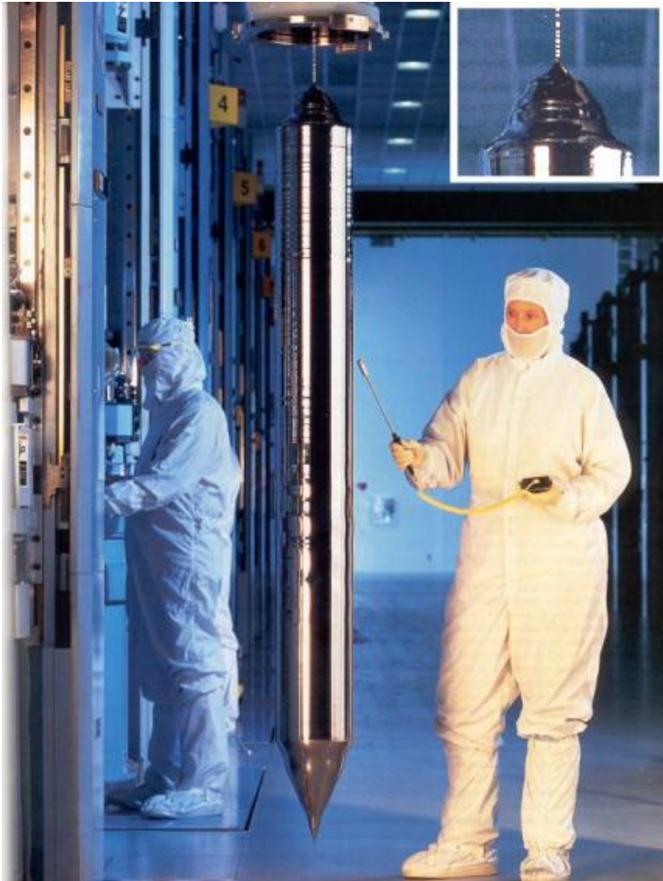
Figure 9 - Monocrystal de silicium obtenu par tirage Czochralski pour une utilisation en électronique
