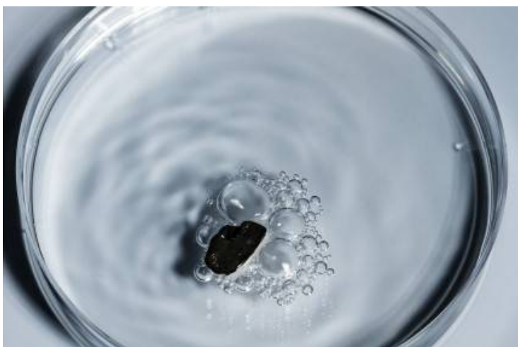
Figure 2 - Réaction du lithium avec l'eau
