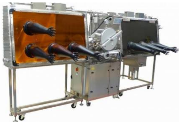
Figure 3 - Boîte à gants pressurisée remplie d'argon ou d'hélium utilisée pour la manipulation du lithium
