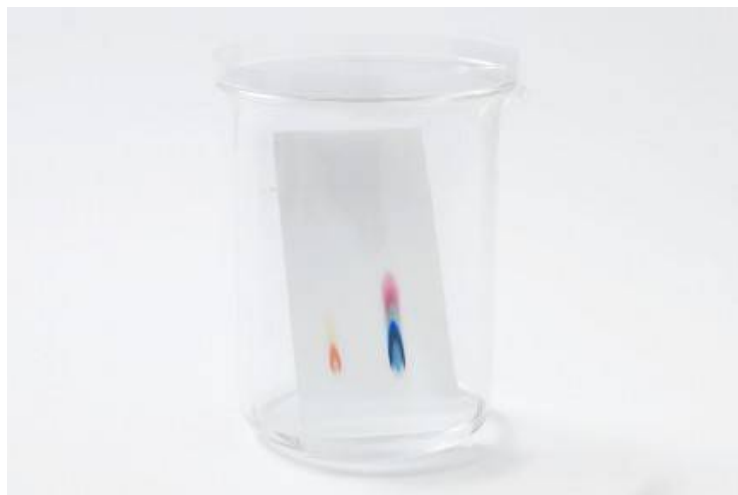
Figure 3 - Chromatographie sur couche mince (CCM)
