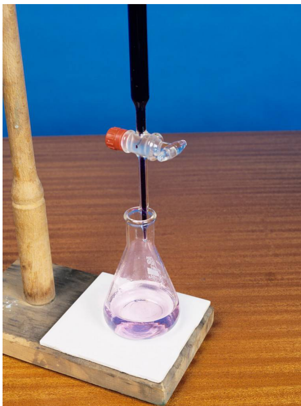
Figure 1 - Titration des ions fer(II) par une solution de permanganate de potassium, placée dans la burette
