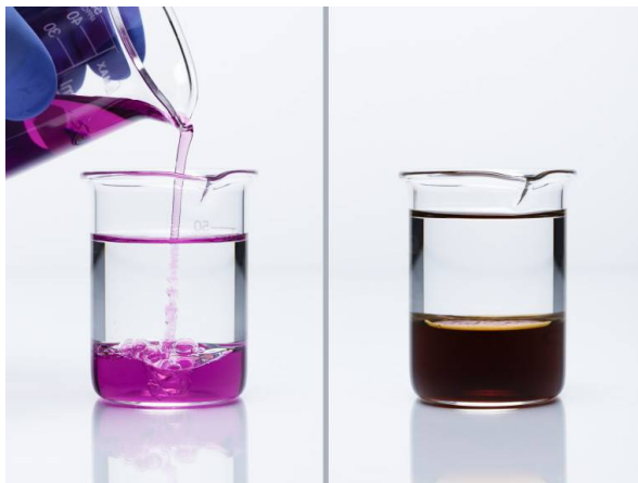
Figure 2 - Oxydation du toluène par le permanganate de potassium
