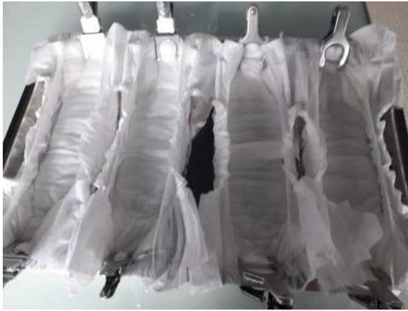
Figure 9 - Mise en place des couches avant ajout du simulant urine
