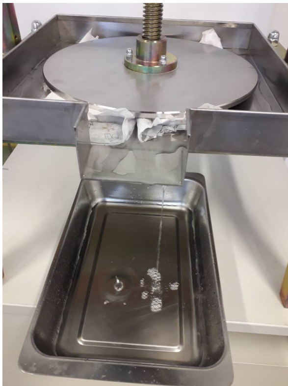
Figure 14 - Pressage des couches
