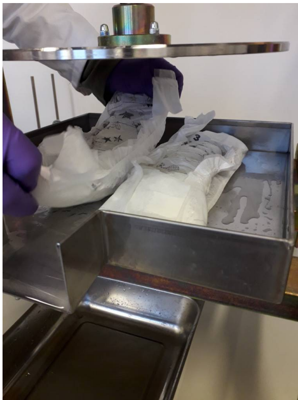
Figure 12 - Positionnement des couches dans le presseur
