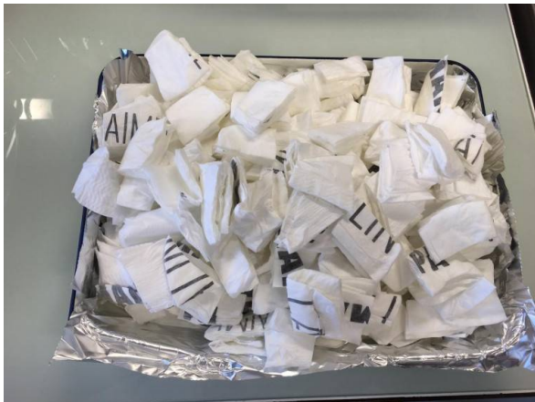
Figure 2 - Couches découpées en carrés de 3 à 5 cm de côté
