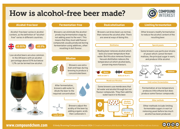
Figure 1 - Comment fabrique-t-on la bière sans alcool ?
