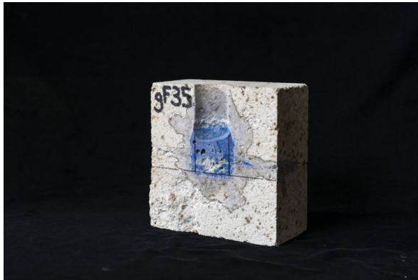
Figure 4 - Échantillon usagé, dit «post-mortem», d'andalousite Échantillon usagé, dit «post-mortem», d'andalousite, céramique réfractaire présentant une excellente résistance aux chocs thermiques et supportant les très hautes températures (jusqu'à 2000°C). Cet échantillon a été utilisé en laboratoire comme creuset dans le but d'étudier ses phénomènes d'altération aux oxydes liquides ou laitiers (en bleu sur l'image). L'andalousite est utilisée dans les industries métallurgique (acier, aluminium), cimentière, céramique et verrière, où elle est le plus souvent utilisée sous forme de briques réfractaires.
