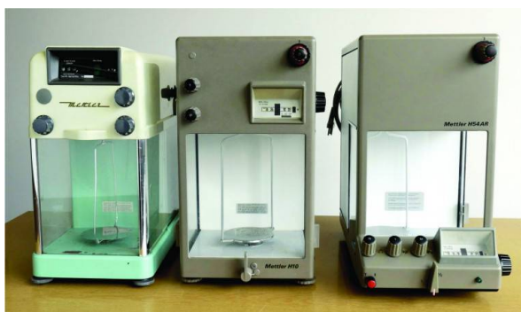
Figure 7 - Exemples de balances des trois séries H de Mettler : à gauche, H6 digCap (Collection UNIL/EPFL, Inv. 603.1038) ; au milieu, H10 (Inv. 603.1035) ; à droite, H54AR (Inv. 603.1037).
