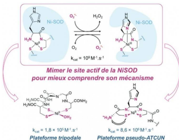
Figure 10 - Des petits complexes biomimétiques permettent d'identifier les paramètres importants pour l'activité catalytique de l'enzyme NiSOD
