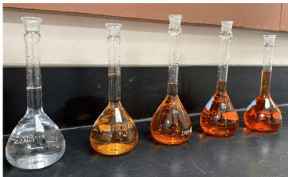
Figure 4 - Dosage spectrophotométrique des ions fer (II) sous forme de complexe avec l'orthophénanthroline
