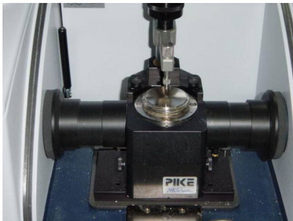
Figure 8 - Dispositif ATR d'un spectromètre IR (cristal en Germanium)
