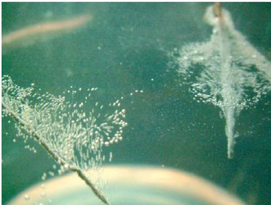
Figure 6. On observe sur les électrodes en platine un dégagement gazeux de dihydrogène à droite et un dégagement gazeux de dioxygène à gauche. (photographie : J. Dodémont).
