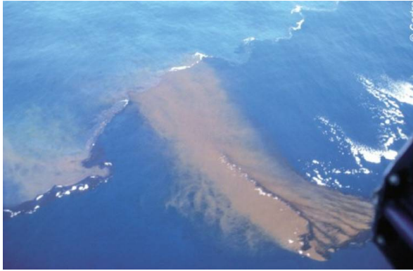
Figure 3 - Au passage de la vague sur la nappe traitée, le pétrole se met en suspension : il apparaît un nuage beige.
