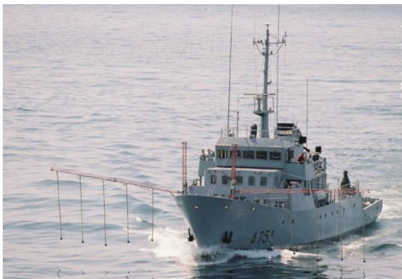
Figure 8 - Des navires de la marine nationale sont équipés pour épandre des produits dispersants. Expérimentation Depol 04, 25-27 mai 2004.
