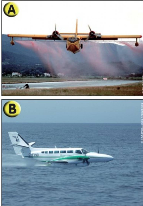
Figure 7 - Épandage aérien dispersant au Canadair. Essai de calibration au sol de l'épandage. Expérimentation Protecmar ; (b) Le Cessna équipé du POD en train d'épandre le dispersant. Expérimentation Depol 04.
