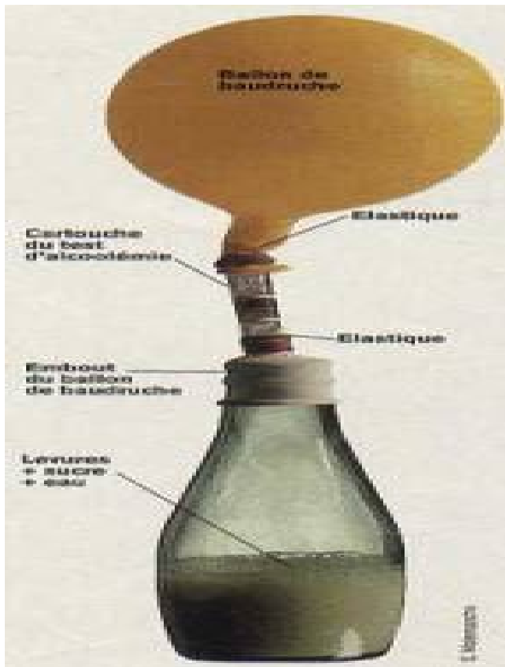
Figure 4 - Mise en place de la manipulation.
