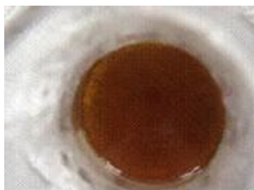
Figure 5. L'eau oxygénée oxyde les ions iodure (en milieu acide) en diiode : on observe une coloration brune et un léger précipité de diiode.
