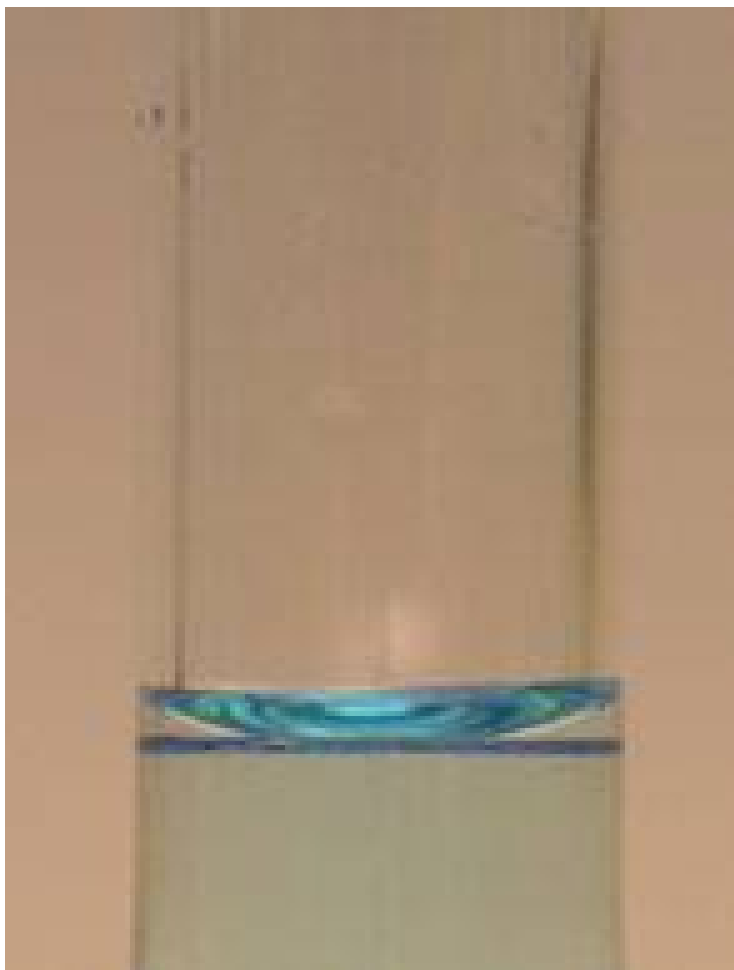
Figure 4 - Ménisque affleurant le trait de jauge lors d'un prélèvement avec une pipette
