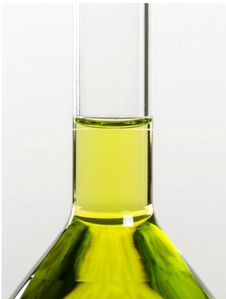
Figure 2 - Remplissage d'une fiole jaugée
