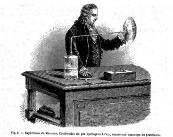
Figure 6 - Combustion du dihydrogène à l'air - Synthèse de l'eau
