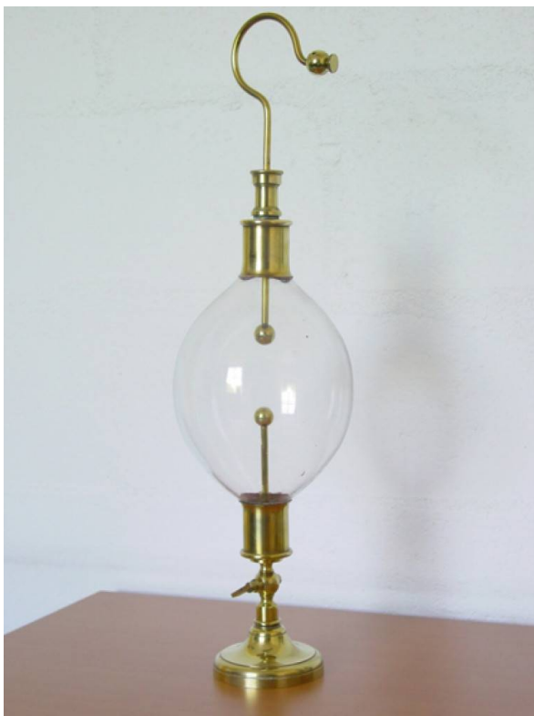
Figure 1 - Appareil de Faraday. Appareil pour étudier les décharges électriques dans les gaz.
