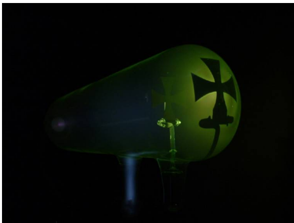
Figure 3 - Mise en évidence des rayons cathodiques. L'arrivée des rayons cathodiques sur la paroi du tube provoque la fluorescence du verre, la croix de malte fait obstacle à ces rayons, on en voit l'ombre sur la paroi du tube.
