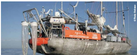
figure 6 - tara, goélette de 36 m de long sur 10 m de large, avec une coque en aluminium permettant de résister aux températures polaires
