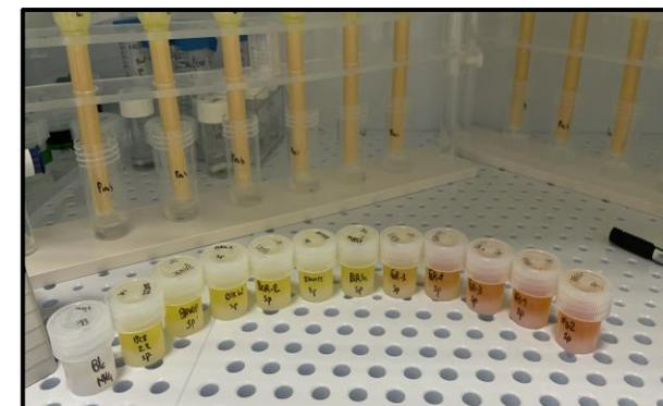
**Dissolution des roches avec des acides et séparation des éléments chimiques d'intérêt en salle « blanche »**
